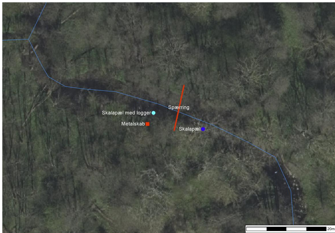
Figur 14: Skitse over hvor spærringen, metalskabet, skalapælene og loggeren er placeret. Vandløbet er vist med en blå streg. Luftfoto fra foråret 2025.
