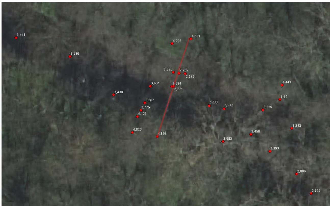
Figur 8: Kotemålinger ved spærringen i Øle Å. Spærringen er markeret med en rød streg og målingerne med røde prikker. Målt d. 07-11-2025.
